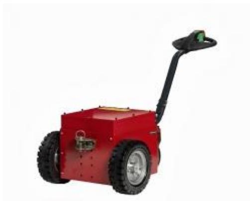
Multi-Mover XL75 – электрический тягач способный буксировать не самоходные колесные грузы (прицеп, тележку, автомобиль) массой до 7500 кг на колесах и 20 000 кг на рельсах.
